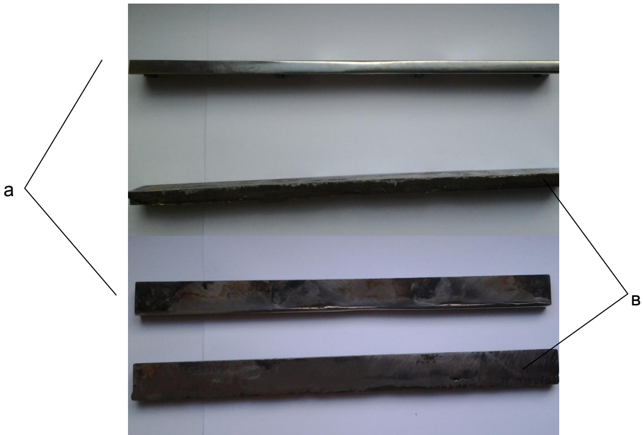
Рисунок 1: Ножи маслодавильных шнеков а - изношенные ножи; в - вновь восстановленные ножи.
