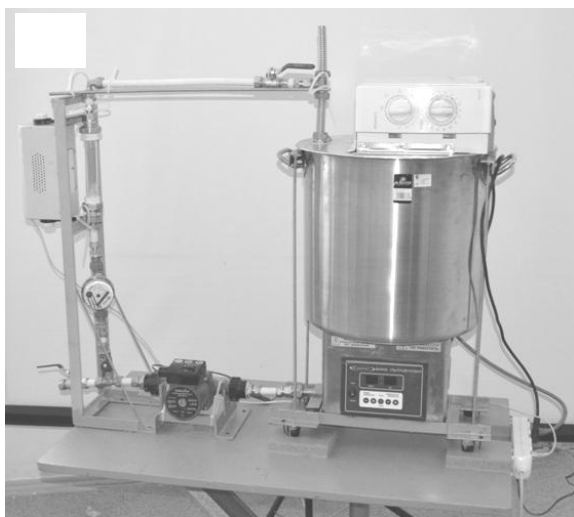
Рисунок 1 – Установка для обеззараживания молока: а) технологическая схема; б) пространственное изображение; в) лабораторный образец установки; 1 – цилиндрический экранирующий корпус, 2 – крышка, 3 – СВЧ генератор, 4 – волновод, 5 – резонаторная камера, 6 – излучатели ультразвуковых колебаний, 7 – УЗ генератор, 8 – насос, 9 – счетчик молока, 10 – трубка из увиолевого стекла, 11 – УФ облучатель, 12 –
