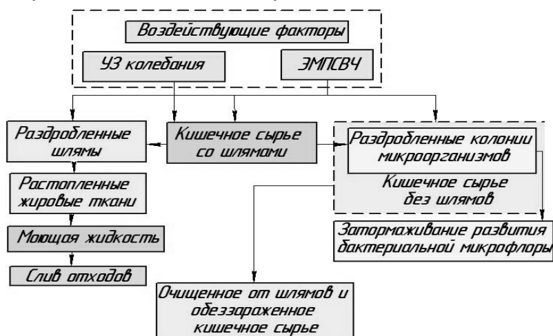
Рисунок 1 – Схема процесса комбинированного воздействия УЗ колебаний и ЭМП СВЧ на кишечное сырье
