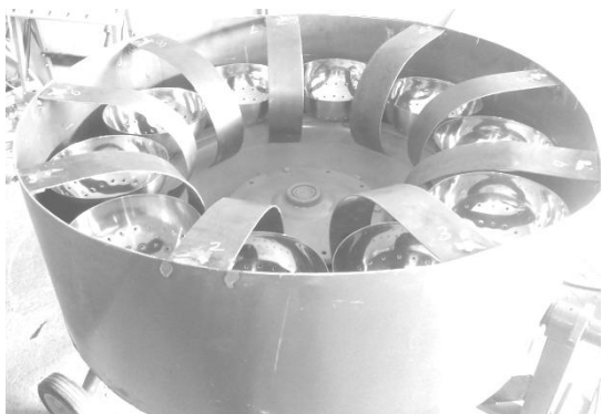
Рисунок 2 – Установка для обезжиривания и обеззараживания кишечного сырья убойных животных без верхнего основания
