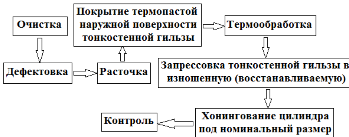
Рисунок 2. Модернизированный способ восстановления гильзы цилиндра ДВС
