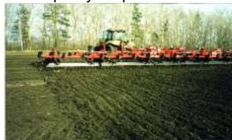
Рис.4г. Культиватор «Horsch» оставляет за собой глыбистую, гребнистую (до 11см.) поверхность, недопустимую по агротехнике возделывания зерновых культур в России
