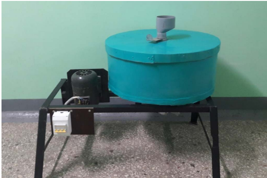
Рисунок 2 – Общий вид устройства для шелушения зерна гречихи с вариативной декой
