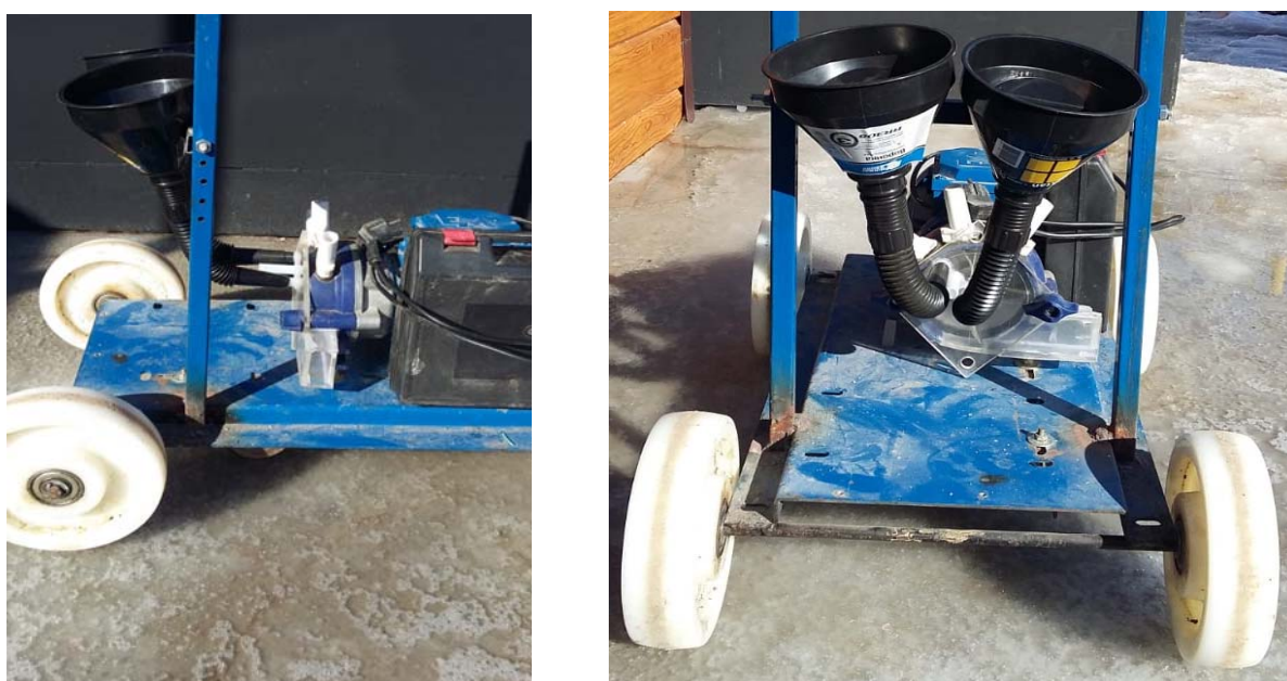
Рисунок 2 – Экспериментальная установка разбрасывателя минеральных удобрений
