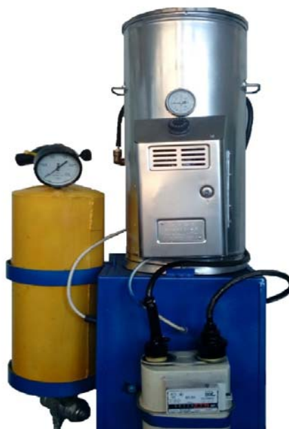
Рисунок 1 – Малообъемная биогазовая установка
