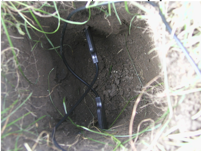
Рисунок 2– Установка датчиков влажности почвы “Decagon 5TE” на разных глубинах
