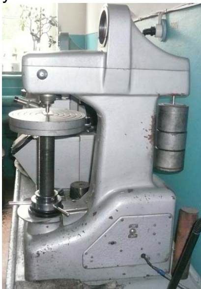
Рисунок 2 – Фотографии общего вида прибора ТК-2М и зоны замера
