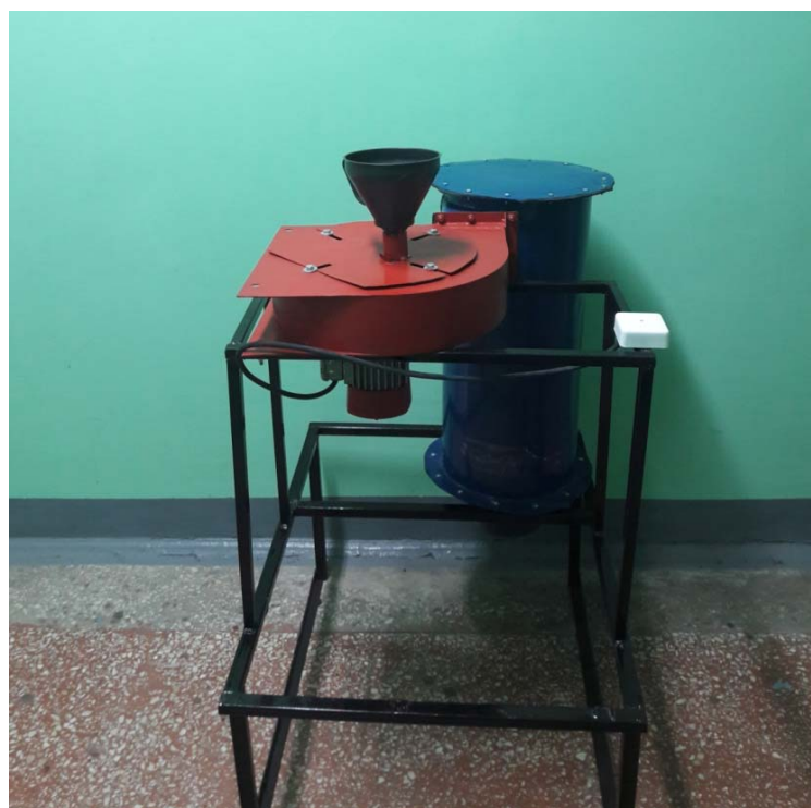
Рисунок 2 – Общий вид пневмомеханического устройства для шелушения зерна
