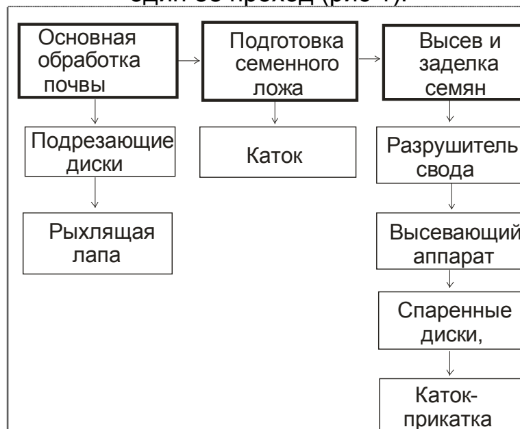
Рисунок 1 - Схема технологического процесса машины
