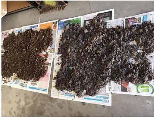
Рисунок 3 – Воздушная сушка образцов почвы
