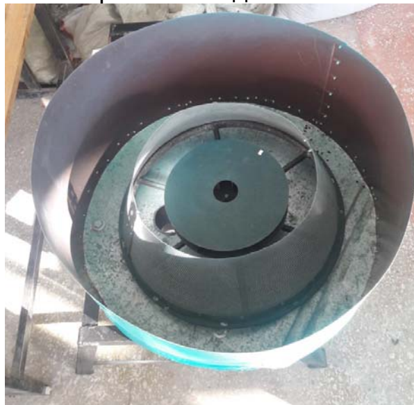
Рисунок 3 – Устройство для шелушения зерна гречихи с вариативной декой без крышки
