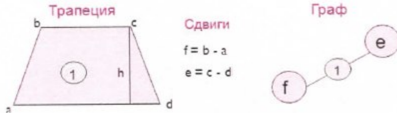
Рисунок 1 – Трапеция и ее представление в виде графа
