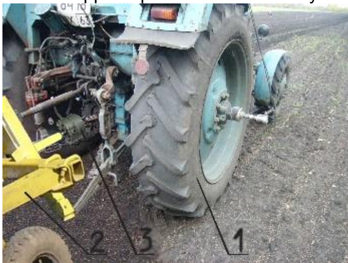
1 – энергетическое средство; 2 – ботвоизмельчитель БИР-4; 3 – карданный динамометр
