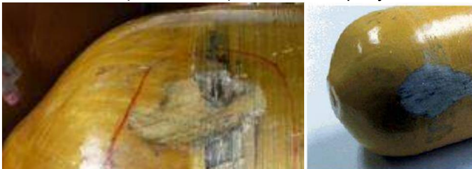
Рисунок 1 - Износ наружной поверхности композитных баллонов, возникший вследствие перемещения в системе крепления
