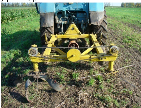
Рис. 1. Тросовый измельчитель ботвы БИР-4, использующийся на тракторе МТЗ-82
