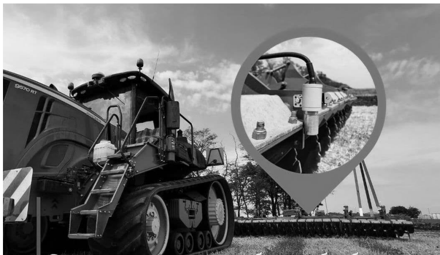
Рисунок 4 – Система контроля глубины обработки для почвообрабатывающей техники
