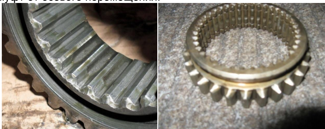
Рисунок 1-Муфта переключения передач до (а [3])и после (б) обработки на токарном станке
