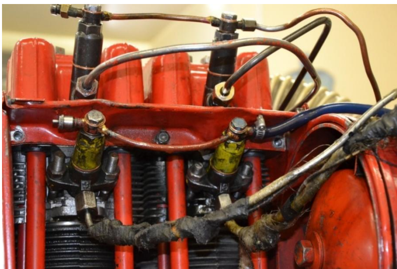
Рисунок 1 – Общий вид головок цилиндра дизеля 2Ч 10,5/ 12,0 с установленными дополнительными форсунками ФС - 6
