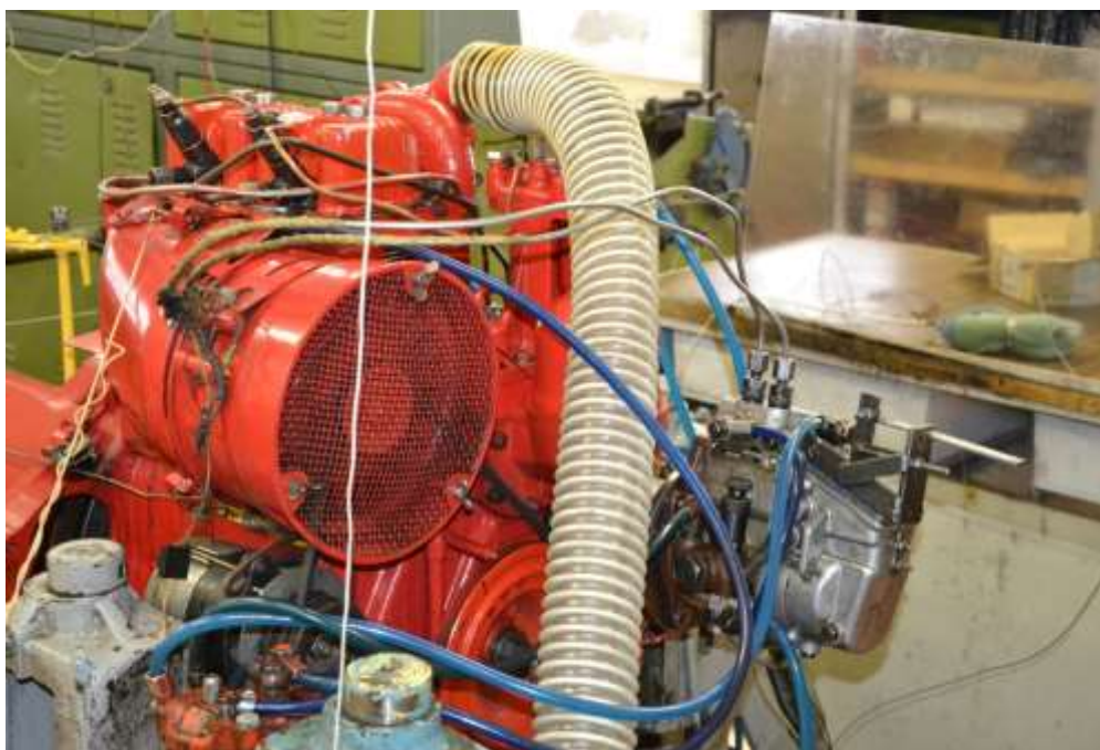
Рисунок 1 – Система топливоподачи модернизированного двигателя Д-21
