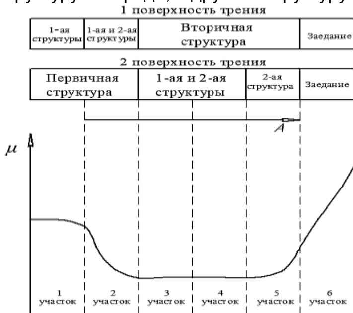
Рисунок 1 – Динамика изменения коэффициента трения в зависимости от нагрузки при разных сочетаниях структур на поверхностях трения
