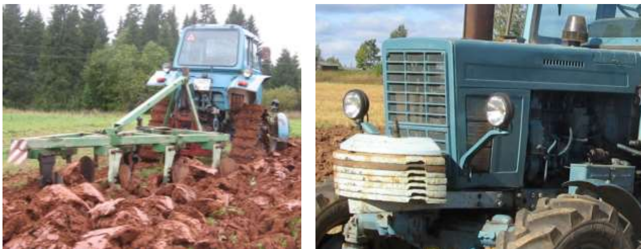
Рисунок 2 – Трактор Беларус 82ГК при работе с четырехкорпусным плугом и противовесы, устанавливаемые на переднюю ось трактора
