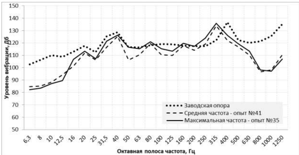
Рисунок 5 - График спектральной плотности вибрации при внешнем воздействии и неизменном моменте на коленчатый вал
