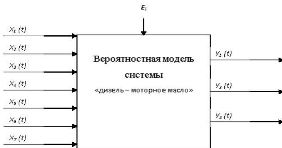
Рисунок 1 - Схема воздействия эксплуатационных факторов на изменение показателей физико-химических свойств масла
