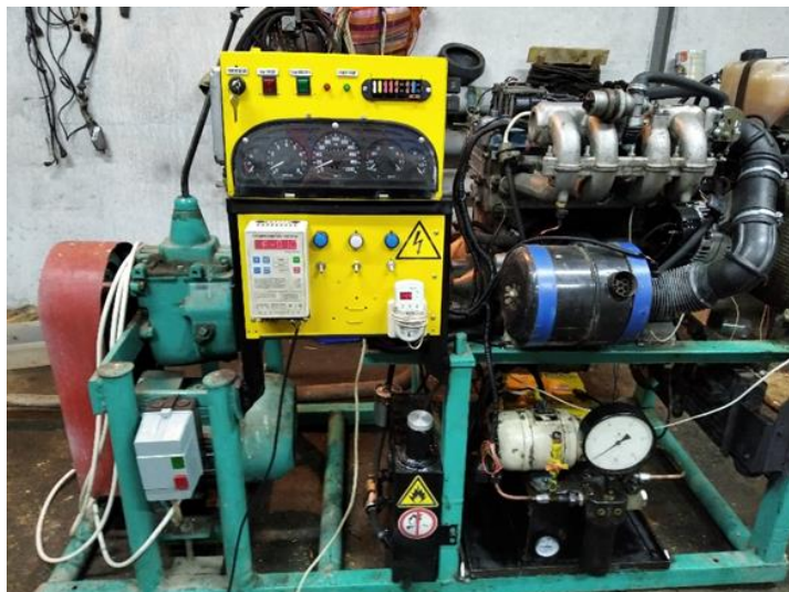
Рисунок 1 – Исследовательская установка на базе двигателя 3М3-4062 с установленным на него турбокомпрессором K27-145 (Strakonice-Чехия)
