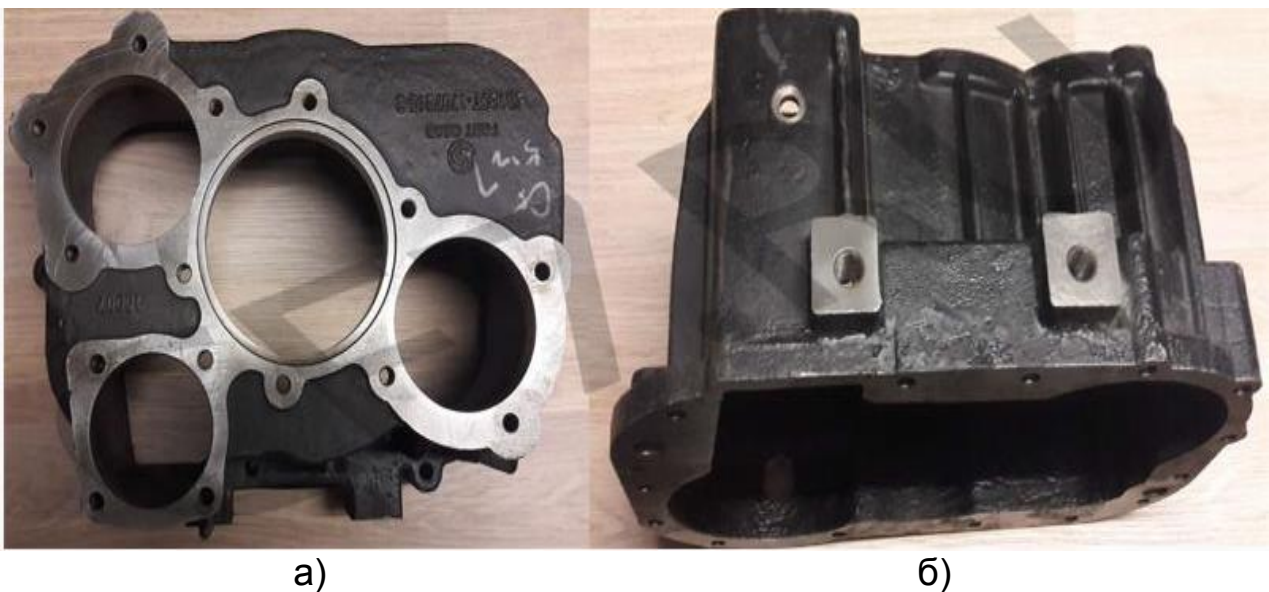
а) вид сверху; б) вид сбоку Рисунок 1 - Корпус задней крышки КПП RTD RTD-11609-1707015
