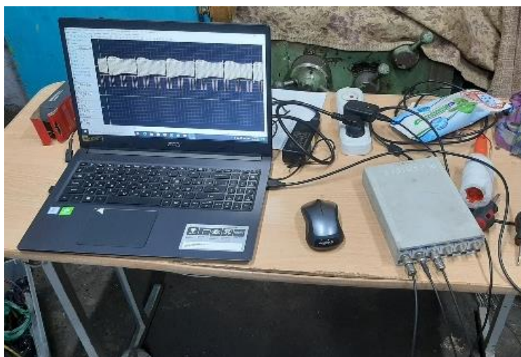
Рисунок 2 - Цифровой осциллограф USB Autoscope III (Осциллограф Постолювского) в процессе измерений параметров
