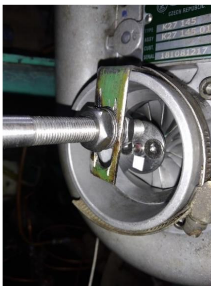
Рисунок 3 - Датчик, установленный на корпусе турбокомпрессора на струбине
