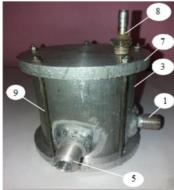
1- магнитное устройство; 2- тепловая трубка; 3-корпус; 4- фильтр; 5 – штуцер; 6 - щелевая трубка; 7 – крышка; 8 – тепловая штуцер Рисунок 1 - Диффузионный аппарат дополнительным магнитным устройством
