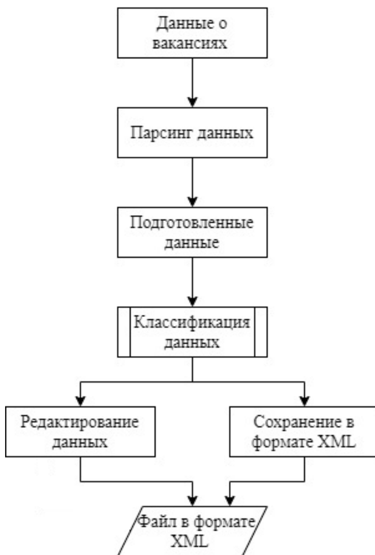
Рис. 11. Структурная схема анализа данных парсинга агрегатора
