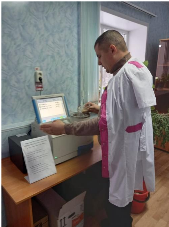
Фото 10. Определение качества зерна яровой пшеницы Йолдыз на ИК анализаторе Информатик 9500
