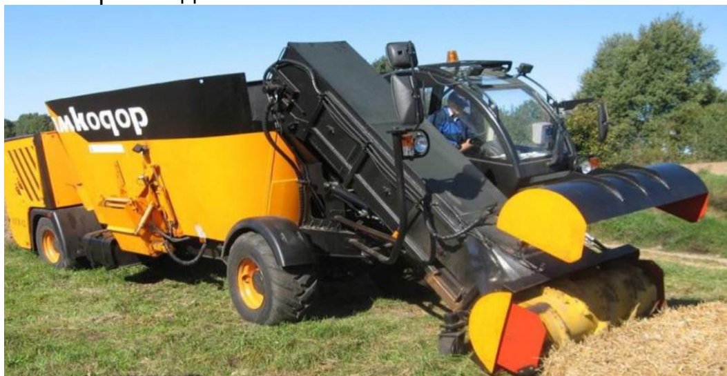
Рисунок 1 – Самоходный смеситель-раздатчик кормов ССР-12
