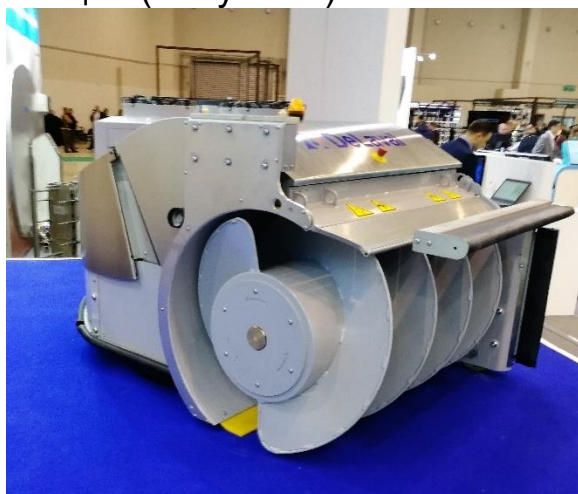
Рисунок 2 – Общий вид пододвигателей кормов фирмы DeLaval Изначально зарубежные роботы подталкиватели кормов предназначались для работы на семейных фермах европейских стран, которые из-за конструктивных параметров не имеют возможности передвигаться на не ровных поверхностях напольного покрытия наших ферм в разные времена года. В связи с этим нашими разработчиками были созданы пододвигатели кормов повышенной проходимости. (Рисунок 3).
