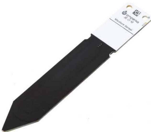
Рисунок 2 – Ёмкостной датчик влажности почвы
