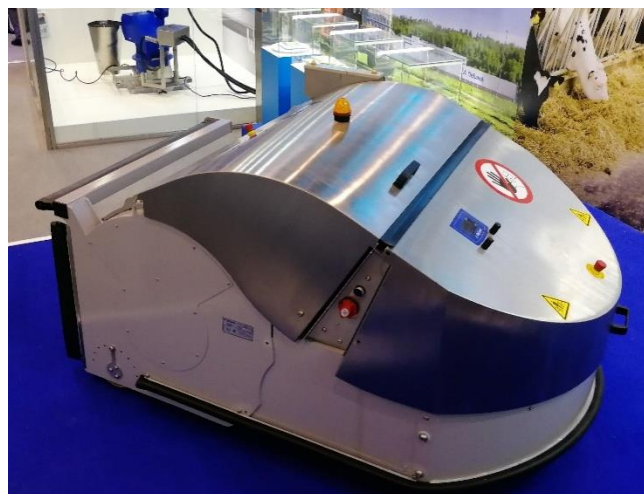
Рисунок 2 – Общий вид пододвигателей кормов фирмы DeLaval Изначально зарубежные роботы подталкиватели кормов предназначались для работы на семейных фермах европейских стран, которые из-за конструктивных параметров не имеют возможности передвигаться на не ровных поверхностях напольного покрытия наших ферм в разные времена года. В связи с этим нашими разработчиками были созданы пододвигатели кормов повышенной проходимости. (Рисунок 3).
