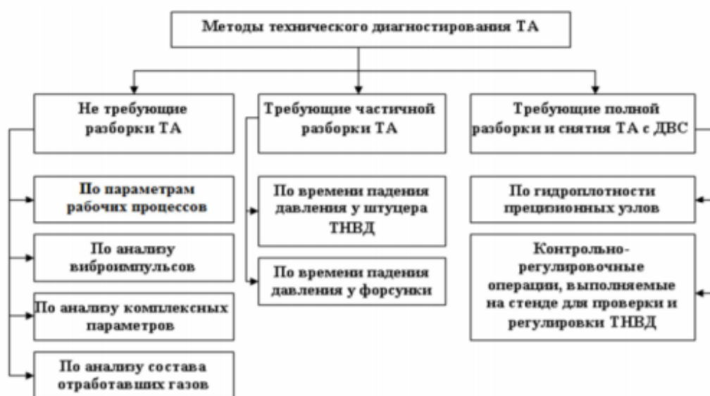
Рисунок 1 – Методы технического диагностирования ТА
