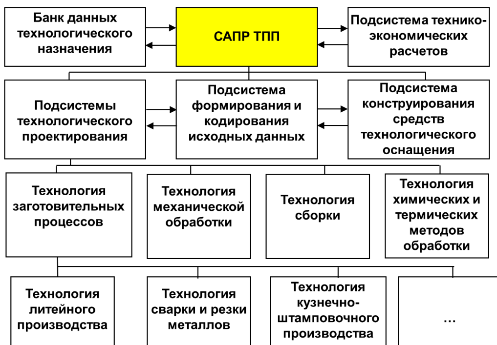
Рисунок 2 - Функциональный состав комплексной САПР ТПП машиностроительного предприятия
