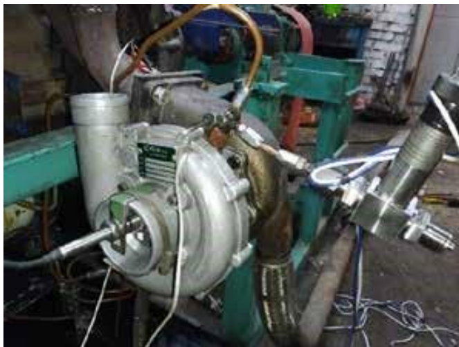
Рисунок 2 - Турбокомпрессор с датчиками для контроля выходных параметров
