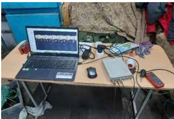
Рисунок 3 - Персональный компьютер с подключенным к нему цифровым осциллографом
