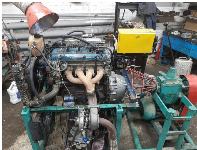
Рисунок 3 – Проектируемая экспериментальная установка с полноразмерным двигателем и устройством нагрузки
