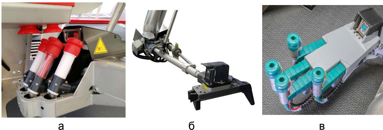
а – Lely Astronaut A5; б – DeLaval VMS; в – Gea DAIRYROBOT r9500 Рисунок 2 – Манипуляторы современных доильных роботов
