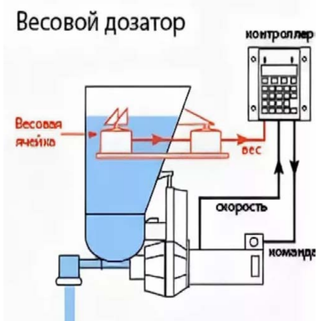
Рисунок 1 – Схема весового дозатора.
