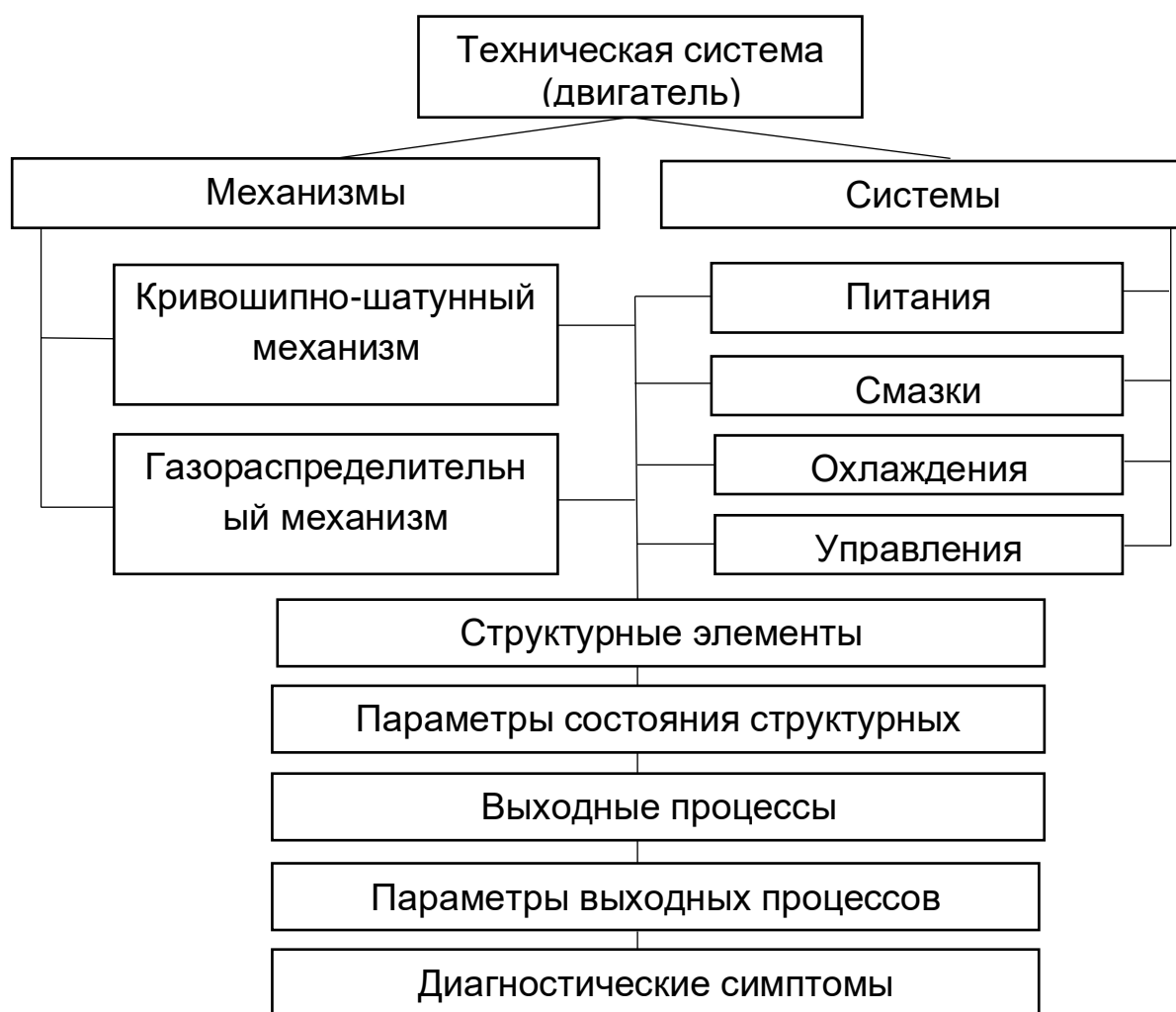
Рисунок 1- Структурно-следственная связь технической системы (двигатель)
