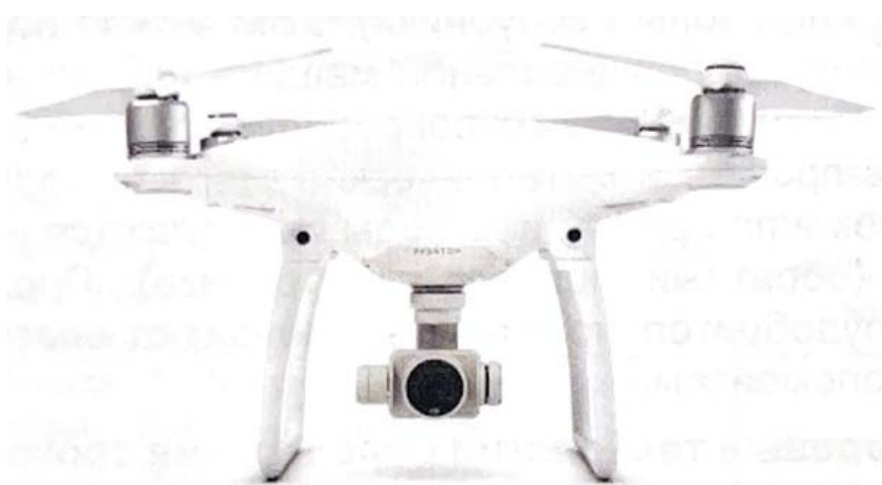
Рис 1. Квадрокоптер «Diyantom 4 Pro» с тепловизором «Flir Boson»
