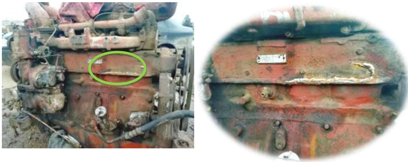
Рисунок 3 – Результат после сварки чугуном электродом
