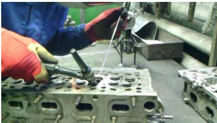
Рисунок 2 – Процесс заваривания трещины блока цилиндров
