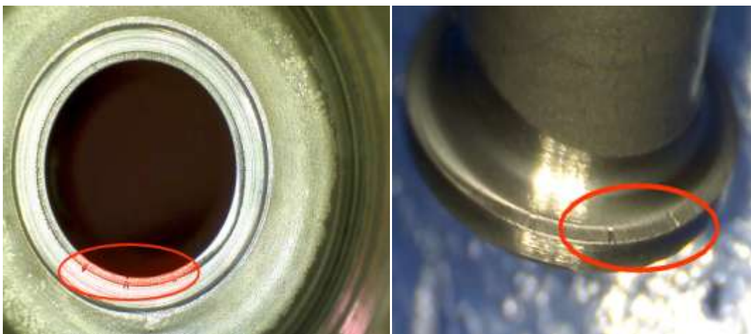
Рисунок 11- Разрушения запорной кромки седла и фаски
