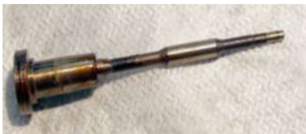
Рисунок 2 -Заклинившийся клапан мультипликатора форсунки CR Bosch
