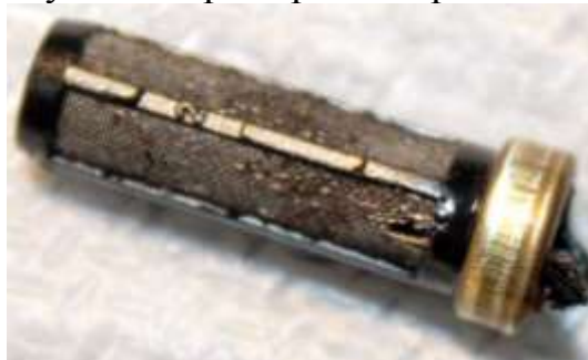
Рисунок 1 - Фильтр забитый грязью и стружкой
