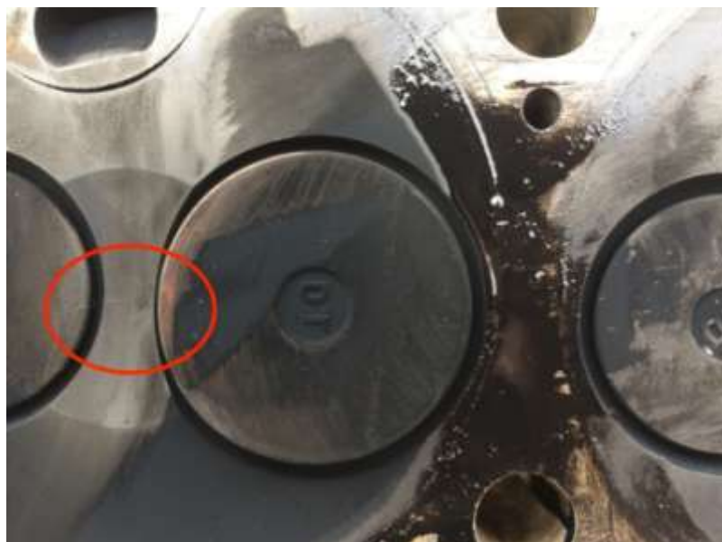
Рисунок 1 – Трещина между впускным и выпускным клапанами
