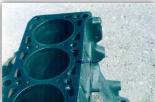
Рисунок 1 – Трещина в чугунном блоке цилиндров
