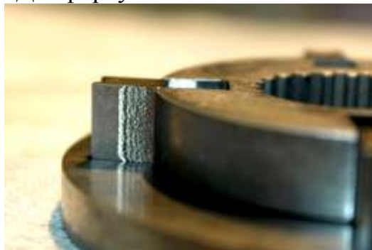
Рисунок 8 - Износ шибера ротора объёмного топливоподкачивающего насоса ТНВД
