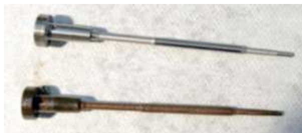
Рисунок 3- Новый и неисправный клапан мультипликатора
