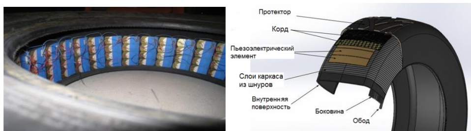
Рисунок 3 – Вариант установки экрана пьезоэлектрических преобразователей на основе ЦТС, размещенного внутри шины и внутри слоистой структуры шины
