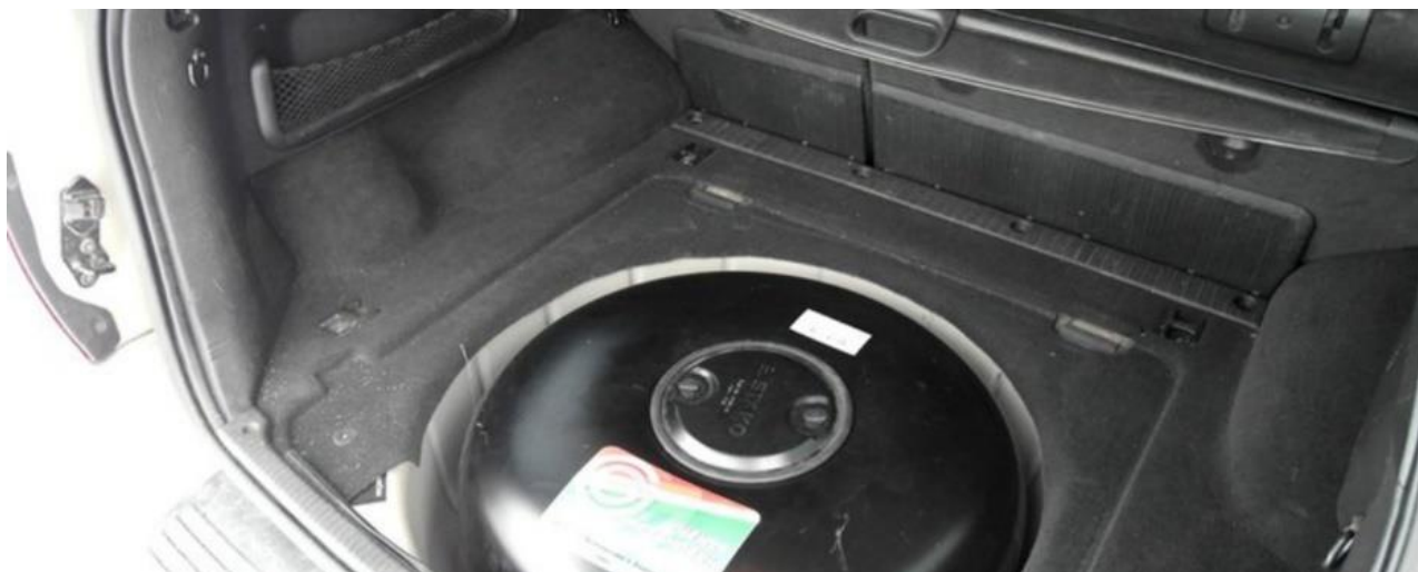
Рисунок 1 - Установка газового баллона вместо запасного колеса
