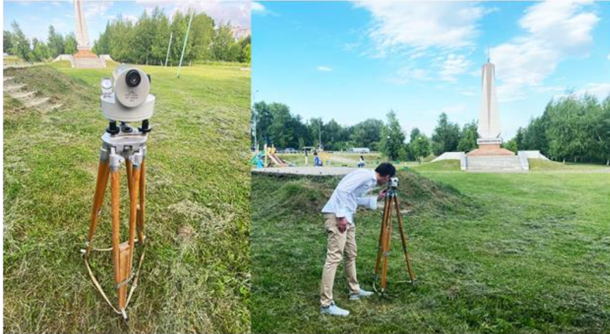
Рисунок 3 - Замер точек высот нивелиром ЗМИ №386
